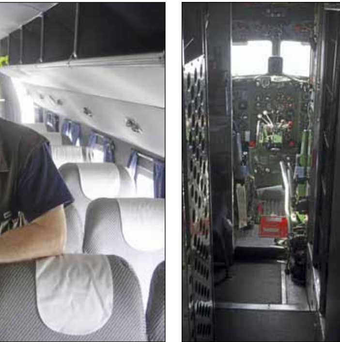
Lattian alla kulkee 38 vaijeria, joilla konetta hallitaan.
